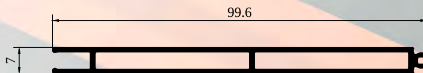
ALX-1995 REVESTIMIENTO TUBULAR GRANDE Peso : 0.694 Kg/m
